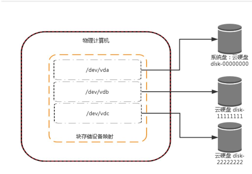
此图显示了 CBS 如何将块存储设备映射到云服务器上：将 `/dev/vda` 映射到系统盘上，并将两块数据盘分别映射到 `/dev/vdb` 和 `/dev/vdc`。
