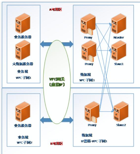
如上图, 以写入数据为例, 假设业务服务器部署在 A 可用区, PC 网关转发数据请求到 A 可用区的 Proxy 网关, 再由 Proxy 做透明转发到 Master 节点。而假设业务服务器部署在 B 可用区, VPC 网关转发数据请求到 B 可用区的 Proxy 网关, 再由 Proxy 做透明转发 (通过云 BGP 专网) 到 Master 节点。无论是读请求还是写请求, 整个过程对业务透明。如果是数据库异常, 数据库集群则按如下原则处理:
